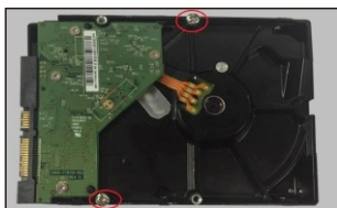
② В отверстия HDD вставьте два винта, не затягивая их.
